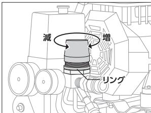
◎使用するエアツールに合わせて、レギュレーターで圧力値を調節してください。
