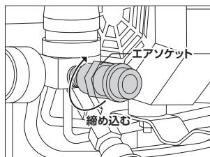
②エアソケットを、19mmレンチを使用し、締め込んで取り付けます。
