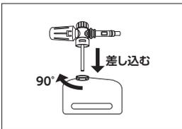
・ シャンプーボトルの差込部の切り欠きを合わせて差し込み、時計回りに90°(止まるところまで)回します。
