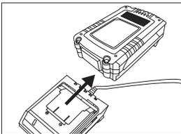
5. 充電完了後は、バッテリーを取り外し、電源プラグをコンセントから抜きます。
