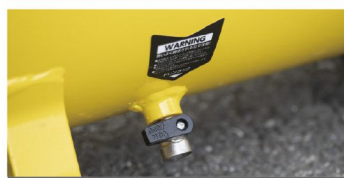
タンク内の空気と水滴を排出するドレンコック
