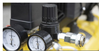
タンクから取り出す圧力値を調節するレギュレーター
