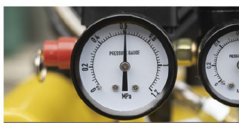
タンク内の圧力値を表示するゲージ
